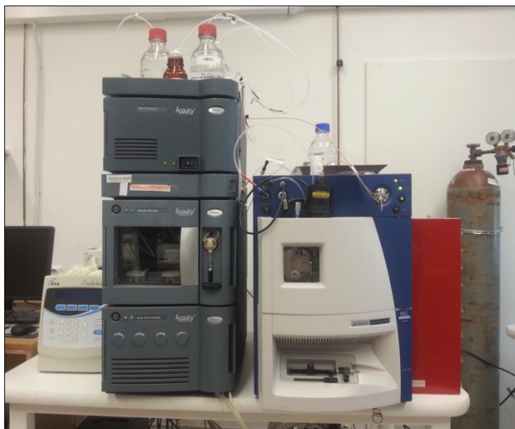
Slika 9. Waters ACQUITY Ultra Performance LC™/Micromass Quattro micro ™ API uređaj (osebna fotografija).
